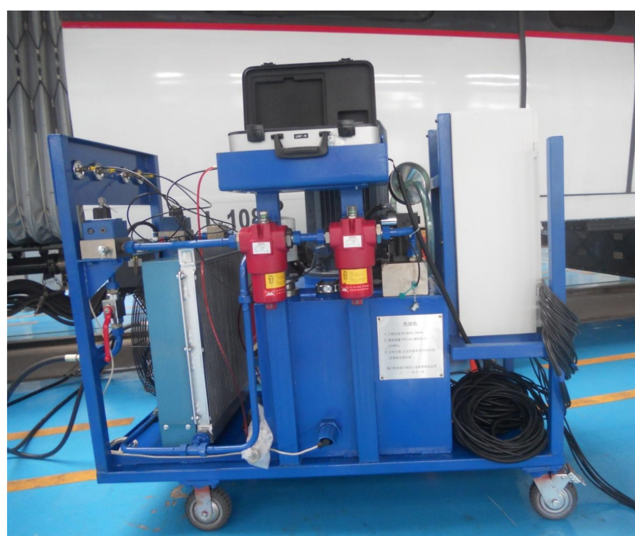
图2 移动式液压管道在线冲洗及清洁度实时检测装置侧视图
