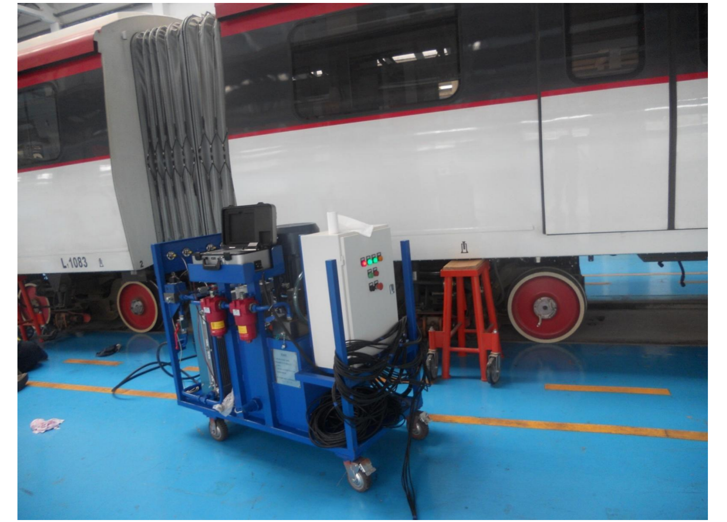
图4 移动式液压管道在线冲洗及清洁度实时检测装置现场工作图2
