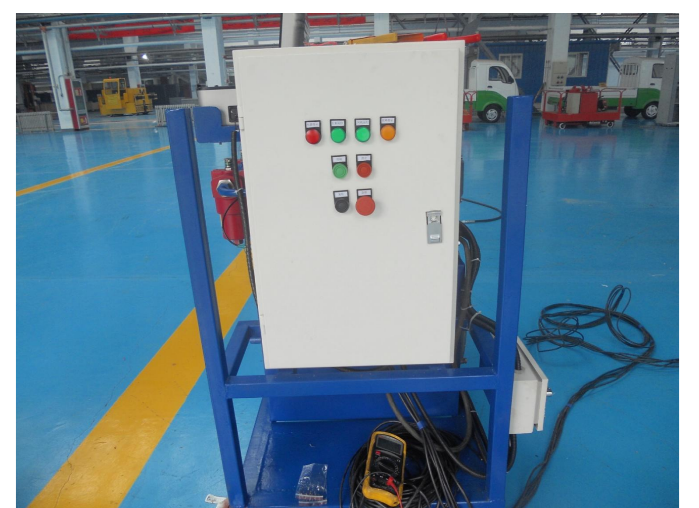
图1 移动式液压管道在线冲洗及清洁度实时检测装置前视图
