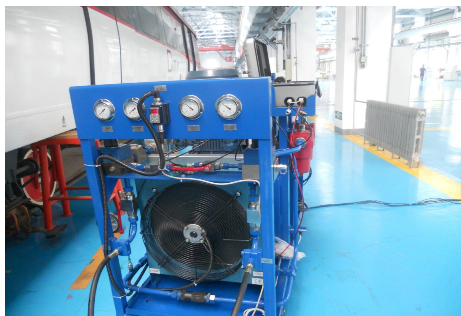
图3 移动式液压管道在线冲洗及清洁度实时检测装置现场工作图1
