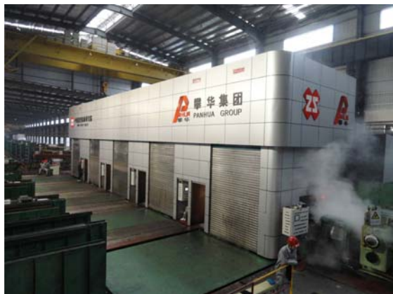
图3 重庆1450五机架全连续连轧机现场
