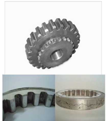
图1 精密锻造的直齿内、外齿轮
