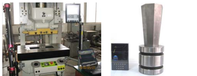
图2 扩径矫圆实验模具及设备
