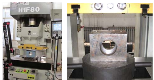
图3 缩径矫圆实验模具及设备
