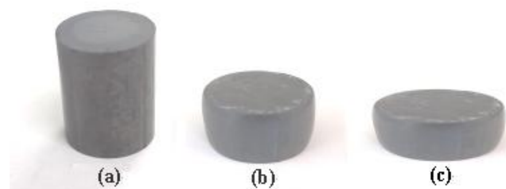
图6 氧化铝陶瓷材料的压缩变形
