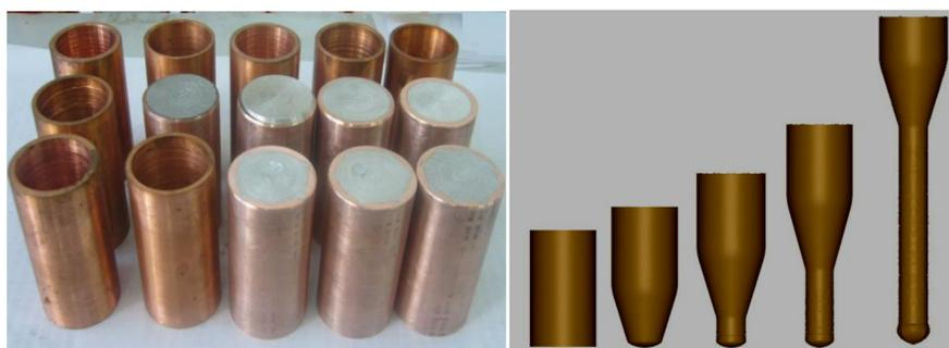
图4 坯料和挤压变形过程
