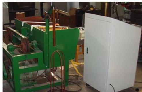
图2 电塑性拔丝机及脉冲电源
