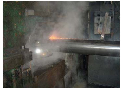
图1 直缝焊管高频焊接过程图
