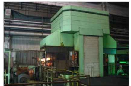
图1 1250 mm六辊冷轧机
