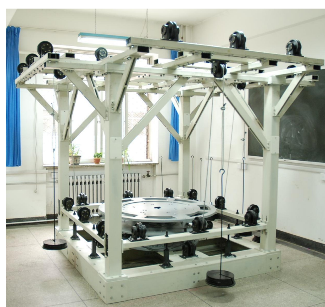
图3 大量程六维力传感器标定装置
