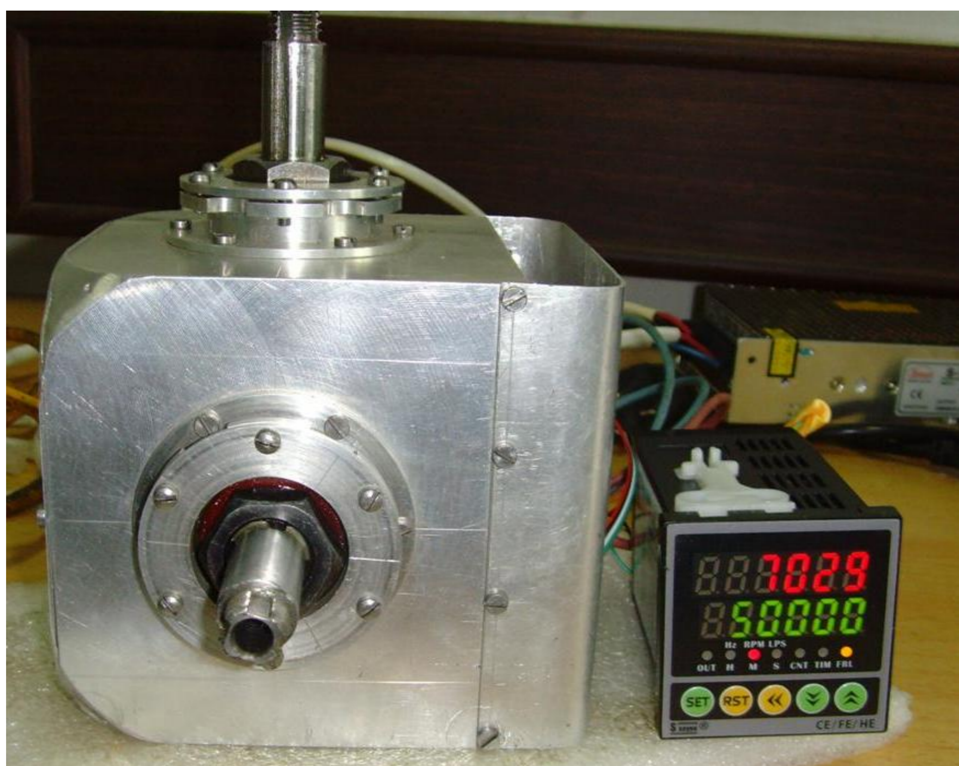
图3 二维驱动单元样机转速测量表实验结果
