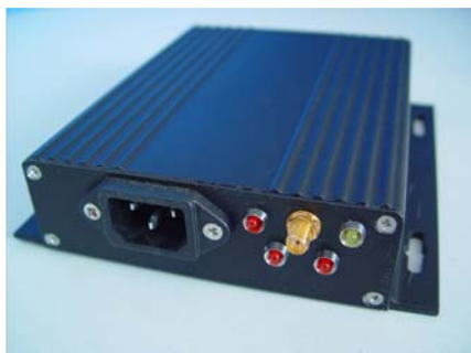
图2 GPRS无线远程数采集体系模块前面板
