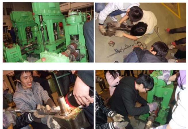
图2 连轧管轧机拆装实验
