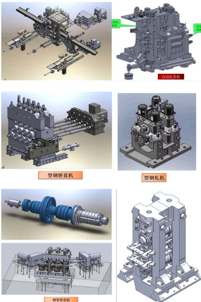
图1 板、管、型钢轧制设备三维实体模型
