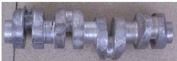
图3 全纤维曲轴实验制品
