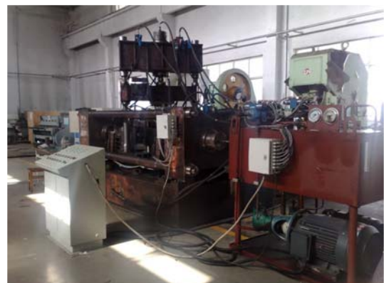
图2全纤维曲轴正交锻弯成形压机样机
