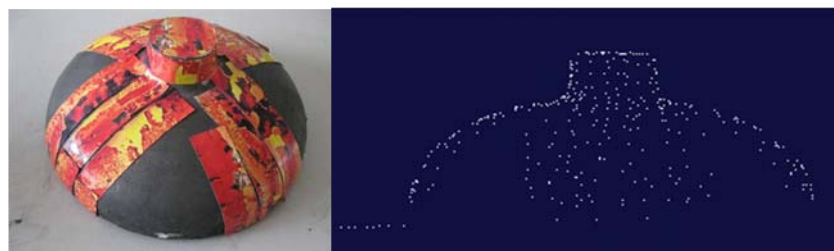
图4 封头模型及系统测量轮廓点云
