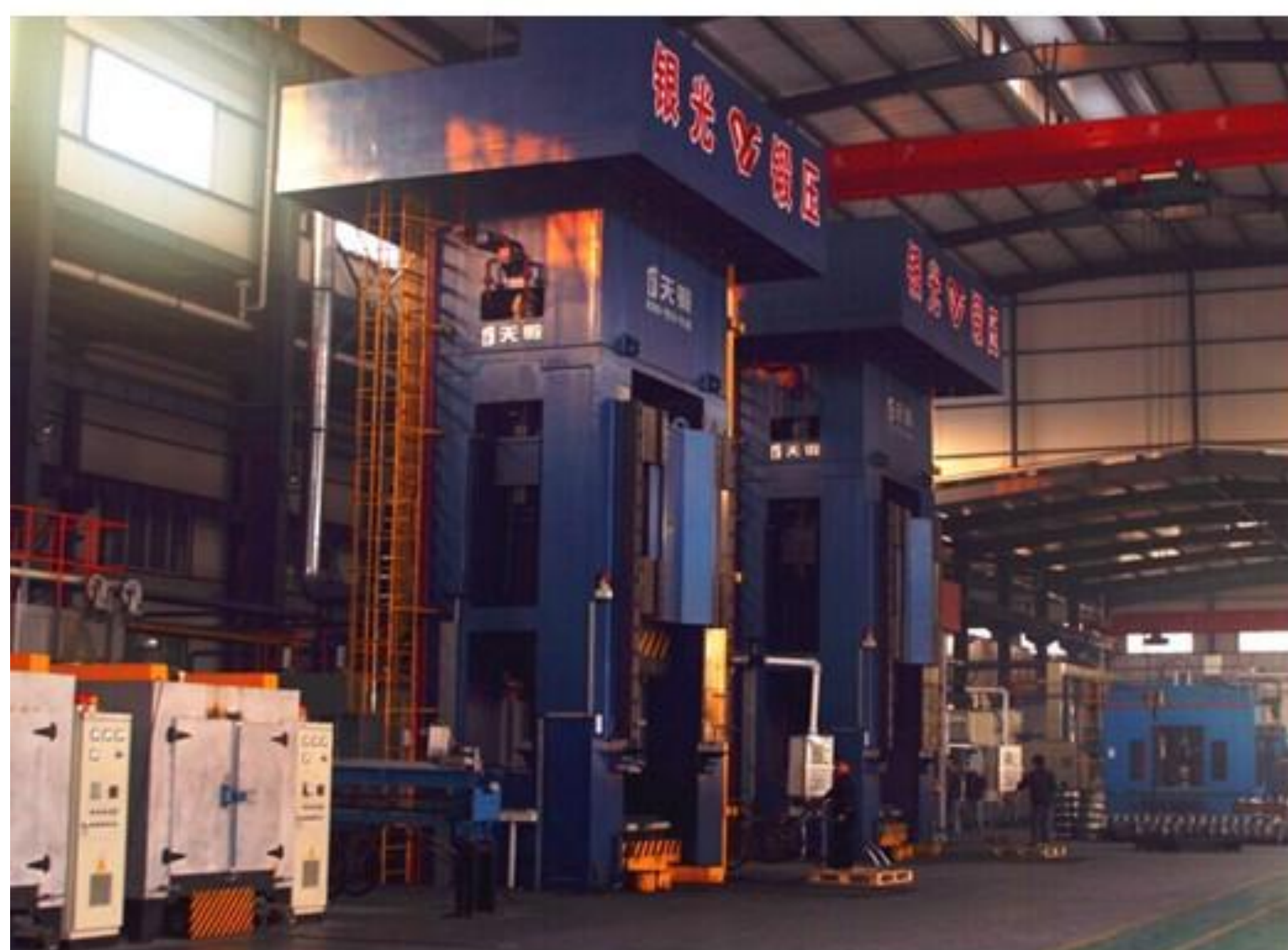
锻造镁合金车轮生产线
