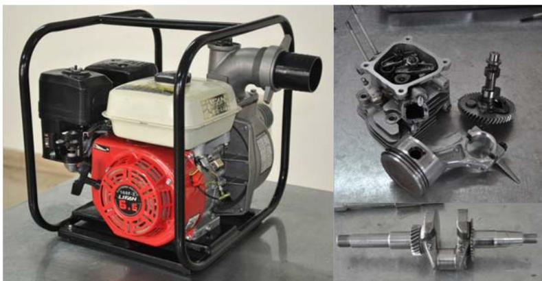
图1 汽油水泵机组及部件
